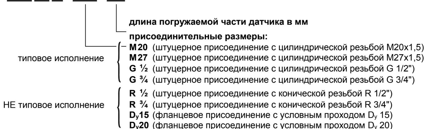
Пример условного обозначения сигнализатора во взрывозащищенном исполнении, со штуцерным элементом крепления с резьбой M20 и длиной погружаемой части датчика 40 мм:
