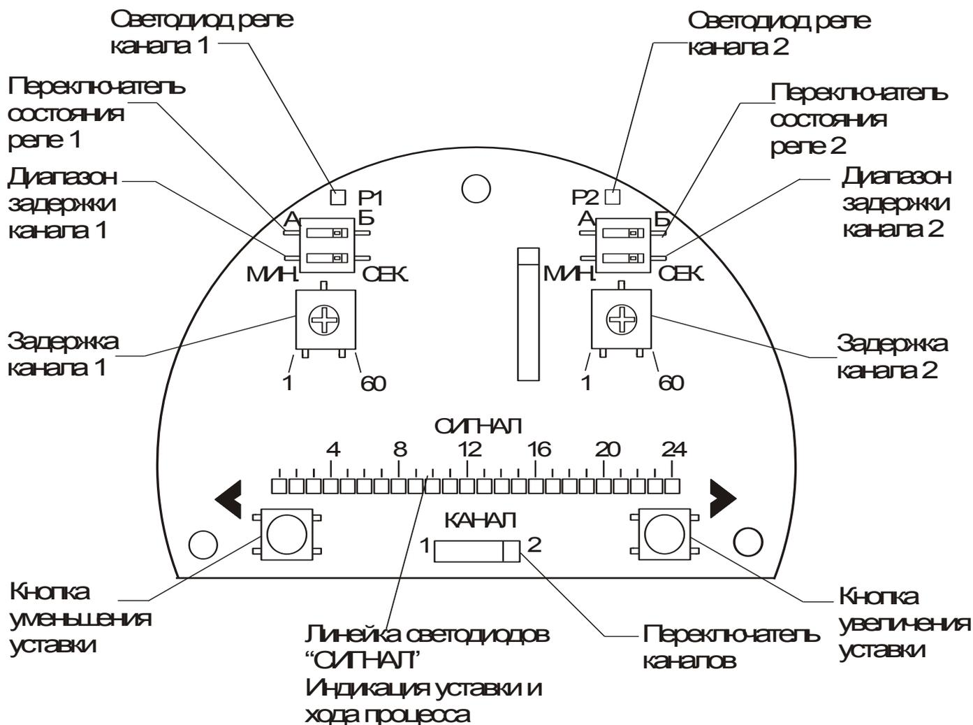
Рисунок 2а – Органы управления и индикации (верхняя плата)
